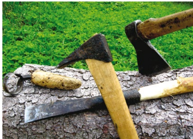
Tradycyjne narzędzia używane do „dziania” barci, od lewej: skobliczka, pieśnia, cieślica i siekiera.
