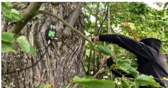
Instalacja tomografu akustycznego na lipie.
