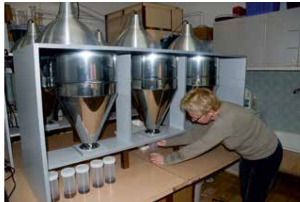
Zainstalowane w Pracowni Naukowo-Edukacyjnej WPN-u aparaty Tullgrena służą do wyplaszania skoczogonków i innych zwierząt z różnych substratów, takich jak próchno czy ściółka.
